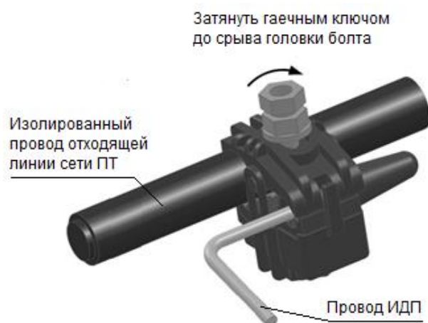
Рис. В11. Установка ответвительного зажима Р616 для подключения проводов ИДП-193и-Х1.Х2.РУ
